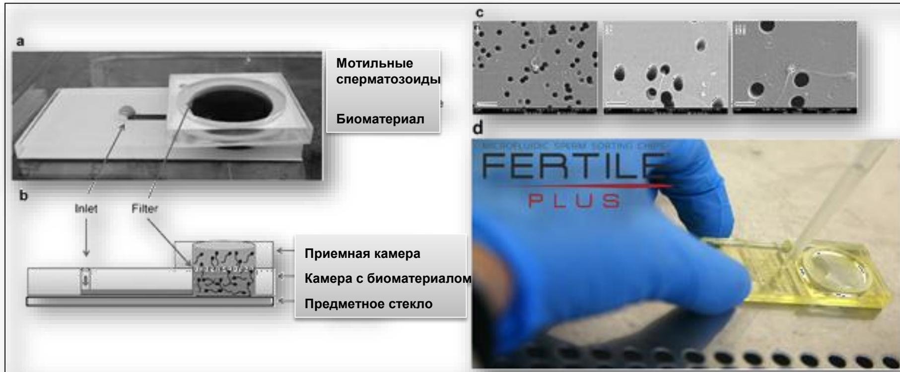
а) Микрофотография микрочипа сортировки спермы
